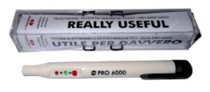
Il rilevatore di poli PRO 6000 permette di controllare in modo rapido, facile e sicuro la polarità di un magnete. Basta solamente appoggiarla a contatto col magnete e premere il bottone rotondo per vedere il risultato. Una luce LED verde indica il polo Sud, mentre una luce LED rossa indica polo Nord. E' un apparecchio molto utile e professionale per identificare la polarità del campo magnetico con il 100% di precisione.
